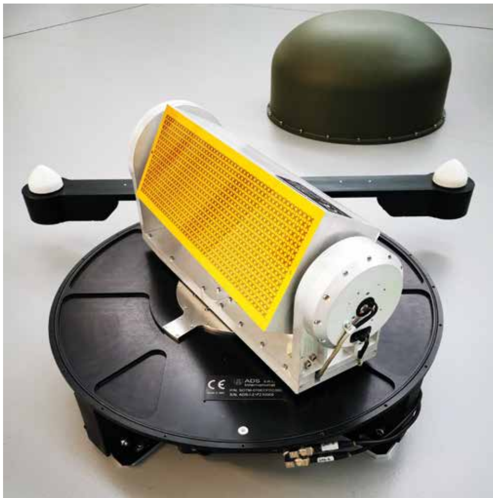
Da sinistra, Massimo Redaelli, technical director di Servotecnica, e Marco Formaggi, business development manager A.D.S. International. L'antenna per comunicazioni satellitari di ADS impiega motori torque Tecnotion e encoder Flux nel sistema azimut e di sollevamento.
